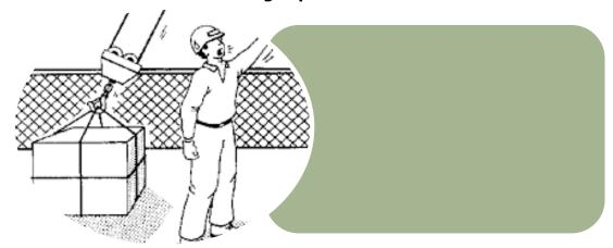
4. Para realizar el izaje, en ocasiones, se ocupan las llamadas eslingas que son aparejos diseñados para conectar la carga que se va a elevar o a mover. Estas son fabricadas en fibras sintéticas y brindan facilidad en el manipuleo y disminuyen el efecto de shocks de carga además de que no se oxidan.
